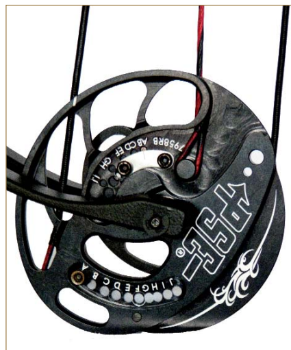
Unteres Cam mit Einstellung für Auszugslängen.
